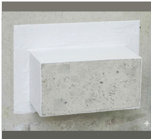
ボス型枠の脱型・ ボス供試体へのシーリング
