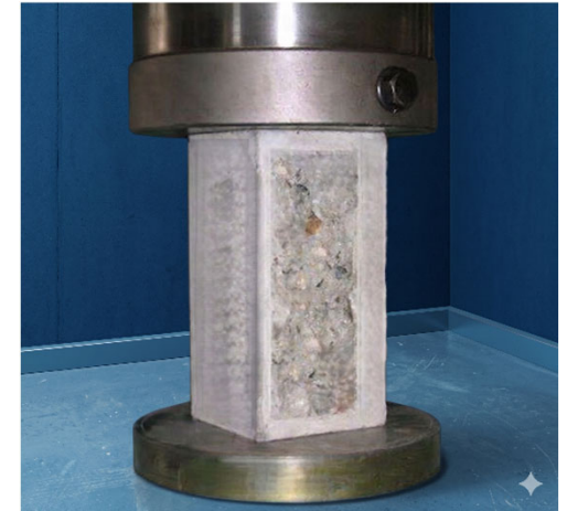
圧縮強度試験
